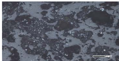
Рис. 8. Проба ТП-1. Кремнистая порода с гематитом (игоночки и тонкая вкрапленность) и гидроксидами железа. Аншлиф, отраженный свет, увел. 100
