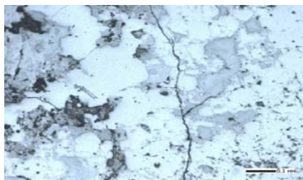
Рис. 10. Проба ТП-3. Пиролюзит-псиломелановая руда. Аншлиф, отраженный свет, увел. 150
